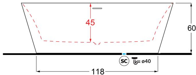
Scarico a terra consigliato filo-pavimento **SC** Recommended grounded drain ø40
