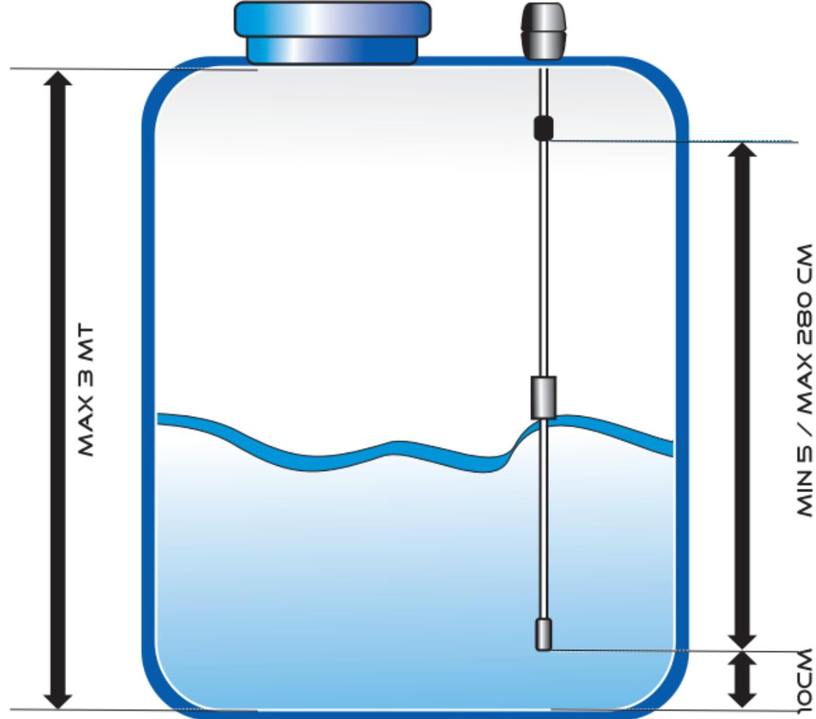
PERMETTE IL CONTROLLO DEL LIVELLO DELL'ACQUA ALL'INTERNO DI UN SERBATOIO O DI UN POZZO.
