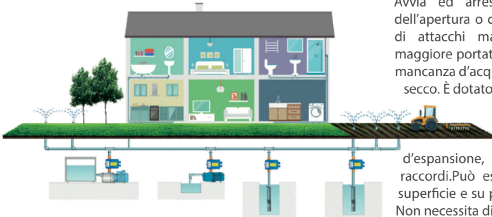
Avvia ed arresta la pompa in funzione dell'apertura o chiusura degli utilizzi. È dotato di attacchi maschio 1"1/4 per garantire maggiore portata. Arresta la pompa in caso di mancanza d'acqua e la protegge dalla marcia a secco. È dotato di riarmi automatici in caso di blocco e di funzione antibloccaggio. Non necessita di vaso d'espansione, valvola di ritegno, filtro e raccordi. Può essere montato su pompe di superficie e su pompe sommerse fino a 3 HP. Non necessita di manutenzione.
