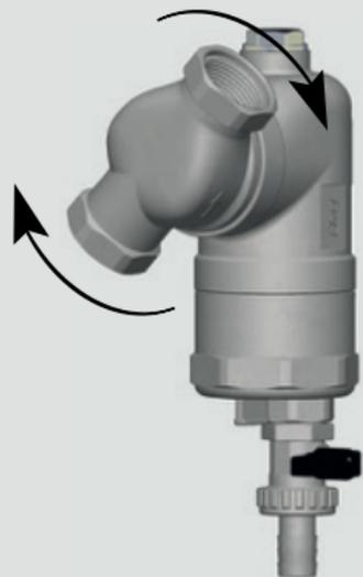
Il defangatore compatto orientabile è adatto all'installazione su tubazioni con disposizione verticale ed orizzontale in quanto la parte con gli attacchi filettati può ruotare di 360° attorno al proprio asse.
