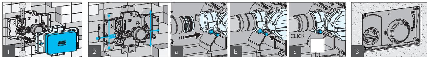
**ATTENZIONE:** durante l'installazione della valvola predisporre in cassetta il tubo corrugato per rendere la valvola remotizzabile.
