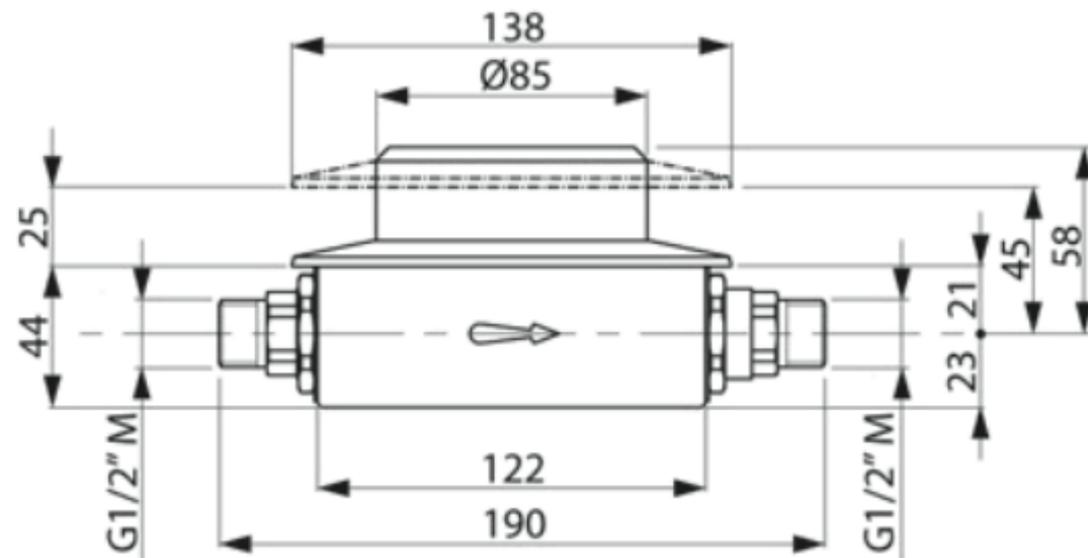
Il contatore interno, anche dopo la posa in opera, è facilmente accessibile e separabile dalla cassetta da incasso: in caso di guasto, è semplice sostituirlo con notevole risparmio di tempo, evitando di dover rompere il muro e le piastrelle.
