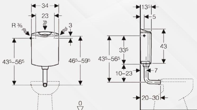
Con rivestimento interno. Completa di rubinetto d'arresto.
