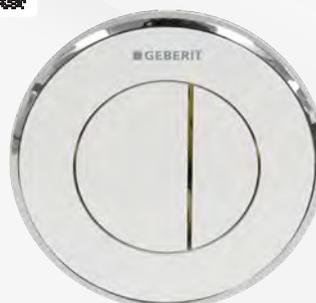
Ø 95 mm. Da utilizzare in combinazione con placca di copertura cieca Art. 73021. Dotazione: comando pneumatico, sollevatore pneumatico, tubicino per l'aria m 2, tubo fodera vuoto m 1,7, materiale per il fissaggio. Compatibile solamente con cassetta incasso Geberit SIGMA 8 (UP720). Caratteristiche Tipo 01. Tasti esterni tipo 10
