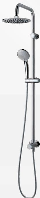
Fissaggio a muro estensibile sino a 30 mm. Supporto doccetta con scorrimento a pressione. Doccetta M3. Diam. 100 mm. Riduttore di portata a 8 L/Min. Asta murale da 1090 mm con diam. 24 mm. Tubo flessibile idealflex, in materiale plastico ad effetto metallico da 1750 mm. \* Disponibile fino ad usurimento scorte
