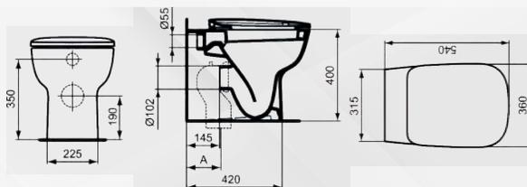
Completo di fissaggio a pavimento, curva tecnica da ordinare a parte. Sistema scarico traslato 50-200 mm. Disponibile fino ad esaurimento scorte.
