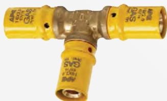
Raccordo a pressare per tubo multistrato. Gli articoli sono dotati di doppio o-ring di tenuta, più anello in PE per eliminare eventuali correnti vaganti. I raccordi vengono utilizzati in impianti di adduzione gas conformi alla UNI/TS 11343. Campo di temperatura: 20-70°C. Pressione di esercizio :MOP 5. Profili di pressata: profilo TH.
