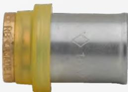
Raccordo a pressare per tubo multistrato. Gli articoli sono dotati di doppio o-ring di tenuta, più anello in PE per eliminare eventuali correnti vaganti. I raccordi vengono utilizzati in impianti di adduzione gas conformi alla UNI/TS 11343. Campo di temperatura: da -20°C a 70 °C - Pressione di esercizio: MOP 5 - Profili di pressata: profilo TH.
