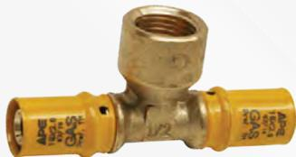
Raccordo a pressare per tubo multistrato. Gli articoli sono dotati di doppio o-ring di tenuta, più anello in PE per eliminare eventuali correnti vaganti. I raccordi vengono utilizzati in impianti di adduzione gas conformi alla UNI/TS 11343. Campo di temperatura: da -20°C a 70 °C - Pressione di esercizio: MOP 5 - Profili di pressata: profilo TH.
