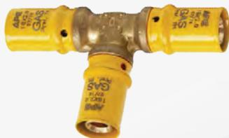
Raccordo a pressare per tubo multistrato. Gli articoli sono dotati di doppio o-ring di tenuta, più anello in PE per eliminare eventuali correnti vaganti. I raccordi vengono utilizzati in impianti di adduzione gas conformi alla UNI/TS 11343. Campo di temperatura: da -20°C a 70 °C - Pressione di esercizio: MOP 5 - Profili di pressata: profilo TH.
