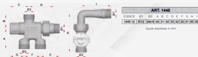
Valvola monotubo "GRT" termostattabile cromata. Attacchi intercambiabili per tubo rame, plastica e multistrato. Sonda esterna e ingresso del fluido termovettore in alto. Interasse derivazioni 35 mm. NB: il tubo di collegamento non è incluso.
