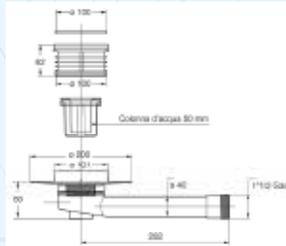
Piletta da pavimento con sifone estraibile a norma EN-274, ad altezza ridotta e dotata di disco all'incollaggio con le guaine, manichetta regolabile in altezza con griglia in acciaio inox 100 x 100 mm Materiale: INOX-PP Colore: Acciaio/Bianco
