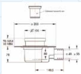
Griglia cromata orientabile, scarico interno Ø 40, scarico esterno Ø 50, grande portata di scarico.
