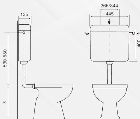
Isolata contro la condensa. Spessore limitato a cm 13,5. Rubinetto a galleggiante. Azionamento meccanico e pneumatico. Tubo Ø 50/40
