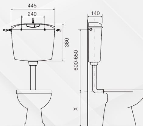
Cassetta di alta qualità, isolata contro la condensa. Tubo di scarico Ø 50/40
