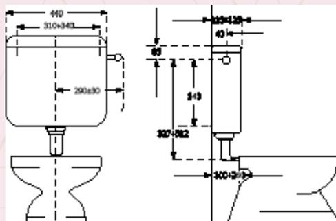
Rubinetto galleggiante 3/8 compatto. Cassetta super piatta di ottima qualità. Completa di tutti gli accessori per il montaggio. Rivestimento interno isolante antisudorazione. Tasto economizzatore d'acqua Start/Stop. 9 lt. Allacciamento dx/sx. Tubo scarico 50x32. Modello: BETA
