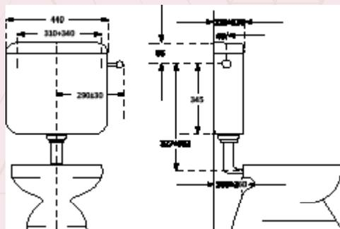
Realizzata interamente in ABS. Cassetta rivestita all'interno con isolante antitrasudazione. 3/9 lt. Senza rubinetto. Galleggiante a scatola 3/8 compatto. Tubo scarico Ø 50x40. Modello: BETA.
