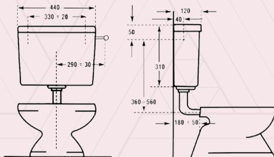
Cassetta super piatta 6/9 lt completa di accessori. Allacciamento alla rete idrica dx/sx. Tasto economizzatore. Senza rubinetto. Galleggiante 3/8 compatto. Tubo scarico 50x32. Modello: EXPORT
