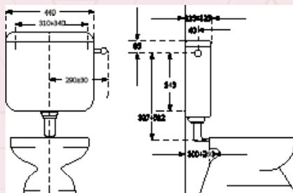
Cassetta super piatta di ottima qualità. Completa di tutti gli accessori per il montaggio. Tasto economizzatore d'acqua Start/Stop 9 lt. Allacciamento dx/sx. Galleggiante a scatola 3/8 compatto. Tubo scarico 50x32. Modello BETA
