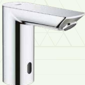
Rubinetto elettronico Bau Cosmopolitan E per lavabo con comando ad infrarossi per acqua fredda o premiscelata. Alimentazione a batteria a litio 6v tipo CR-P2. Durata batteria circa 7 anni (1150 cicli giornalieri). Corpo realizzato in polimero composto con elettrovalvola integrata, batteria esterna, spia di controllo della batteria, 7 programmazioni.
